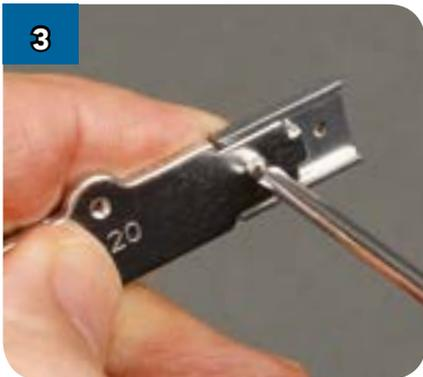
Скрепите деталь (BF-20) и соединительную накладку винтом 2 x 4 мм.
