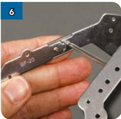
Прикрепите конец детали (BF-19) к соединительной накладке винтом 2 x 4 мм.
