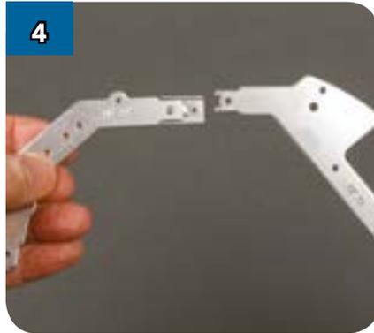
Поднесите к получившейся конструкции конец детали (BF-19) (см. фотографию) так, чтобы номера обеих деталей оказались с одной стороны.
